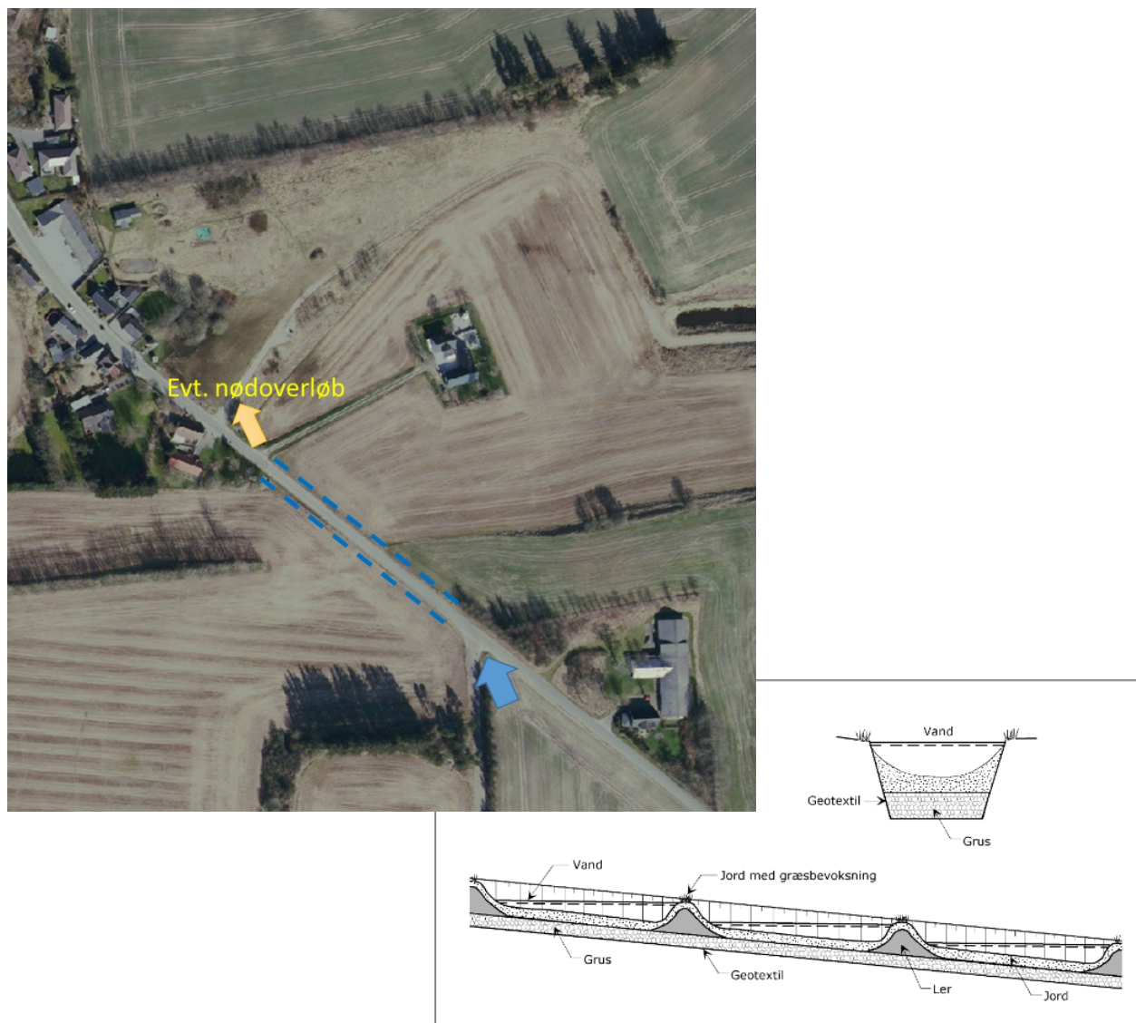
Figur 3.5 Grøft med dæmninger for opstuvning og øget nedsivning af vandet.
